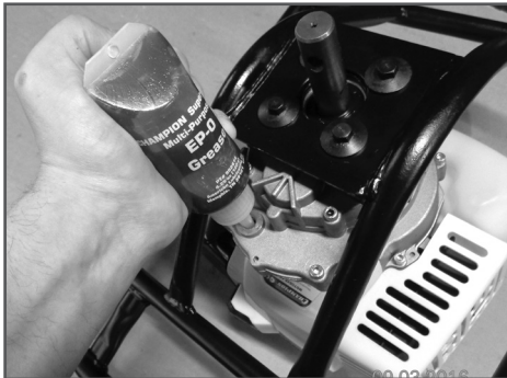
Рис. 15 Добавление смазки в корпус редуктора
